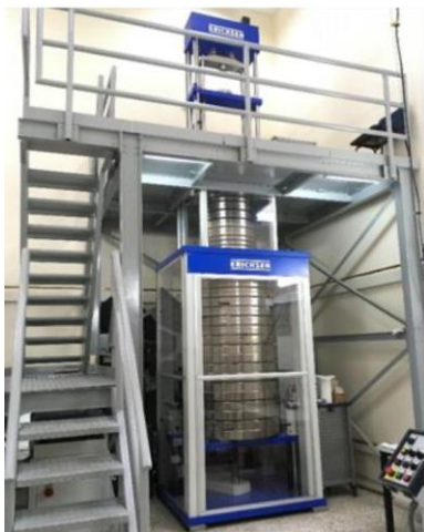
Proyecto de modernización del patrón nacional de fuerza de 100 kN
