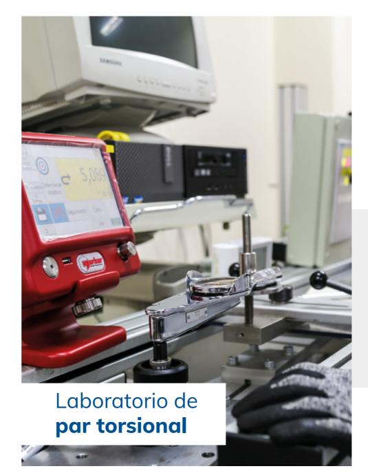
La magnitud par torsional toma como referencia la medición de dos fuerzas en torsión. En otros términos, para que una torsión exista se requieren dos fuerzas (par), paralelas y separadas en sentido opuestos sobre el mismo cuerpo.
