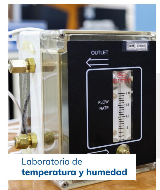
Este laboratorio tiene a su cargo la realización y la diseminación de los patrones nacionales de temperatura y humedad. Para ello cuenta con un conjunto de medios de comparación para la calibración de termómetros de contacto, termómetros de radiación e higrómetros.
