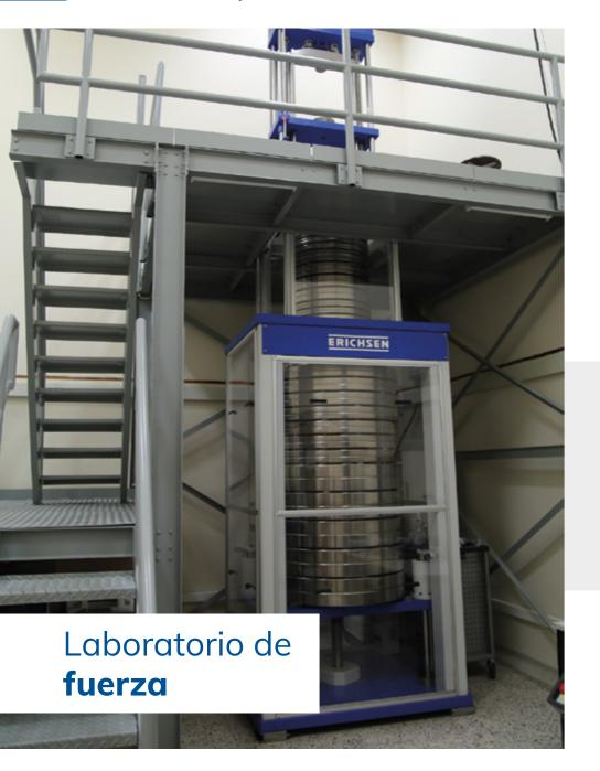
Este laboratorio custodia y mantiene los dos patrones nacionales de fuerza primarios de un kilonewton y de diez kilonewton. Presta servicios de calibración en unidades de fuerza y unidades relacionadas a equipos de ensayo de materiales, gatos y prensas hidráulicas, dinamómetros y tensiómetros, transductores de fuerza, celdas de carga, entre otros.
