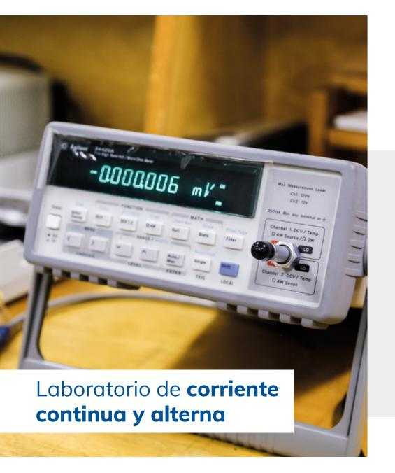
Este laboratorio custodia y conserva los patrones nacionales de medición de seis (6) magnitudes eléctricas: tensión continua, tensión alterna, intensidad de corriente continua, intensidad de corriente alterna, resistencia y capacitancia. El laboratorio presta servicios de calibración en unidades eléctricas.
