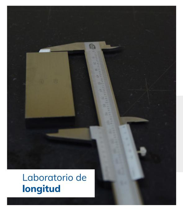
Este laboratorio custodia y mantiene los patrones nacionales de dimensional, incluidos juegos de bloques, reglas de paso, cinta métrica e interferómetro y presta servicios de calibración en mediciones longitudinales, geométricas y dimensionales a instrumentos como bloques calibre, micrómetros, calibradores pie de rey, comparadores, cintas métricas, reglas graduadas, entre otros.
