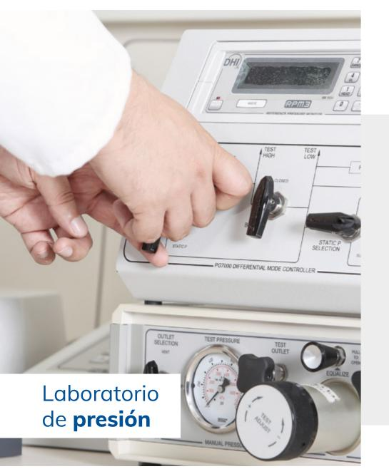
Este laboratorio se encarga de custodiar y mantener los patrones de referencia en esta magnitud. Para su diseminación el laboratorio cuenta con un conjunto de patrones con los que se realizan mediciones en presión hidráulica y neumática.
