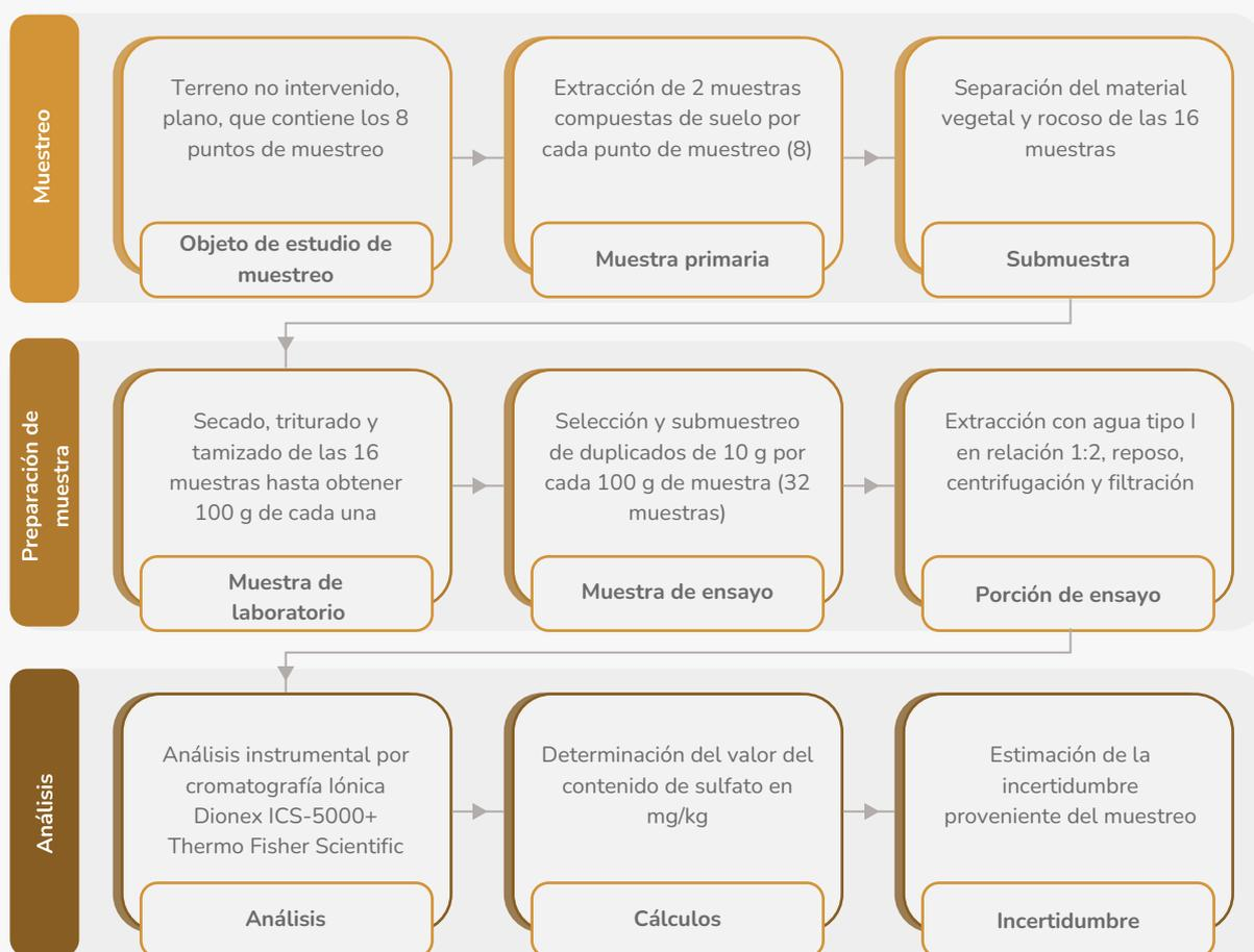
Figura 13. Proceso de medición de sulfatos disponibles en suelos.
