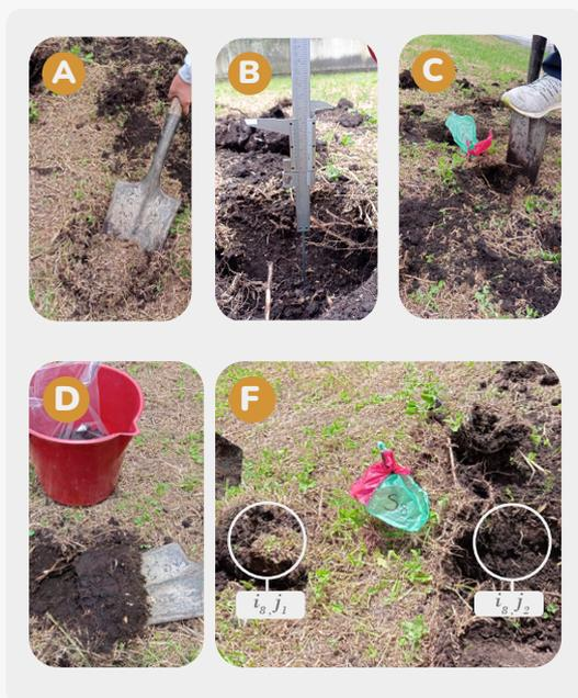
**Figura 16.** A) abertura transversal; B y C) toma de porciones en el horizonte superior; D) toma de muestras y E) punto  $i_8$  del cual se tomaron muestras primarias  $j_1$  y  $j_2$
