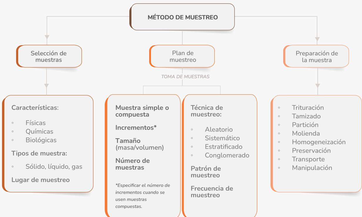
**Figura 2.** Relación entre el método de muestreo, la selección de muestras, plan de muestreo y preparación de la muestra.
