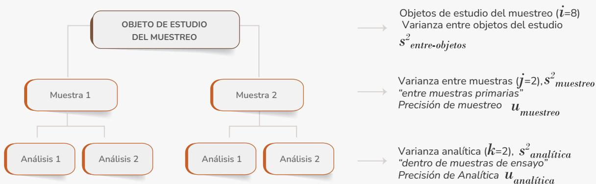
**Figura 11.** Diseño anidado balanceado en dos etapas, con doble división, utilizando el método duplicado. Tomado y adaptado de: Ramsey, Ellison y Rostron, Eurachem, 2019.
