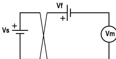
Obteniendo un valor medido de  $V_{m-} = -V_S - V_f$
