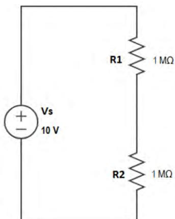
Se desea realizar la medición de tensión eléctrica sobre una de las resistencias  $V_{R2}$ , idealmente debería ser 5 V, teniendo en cuenta que corresponde a un divisor de tensión con dos resistencias iguales:
