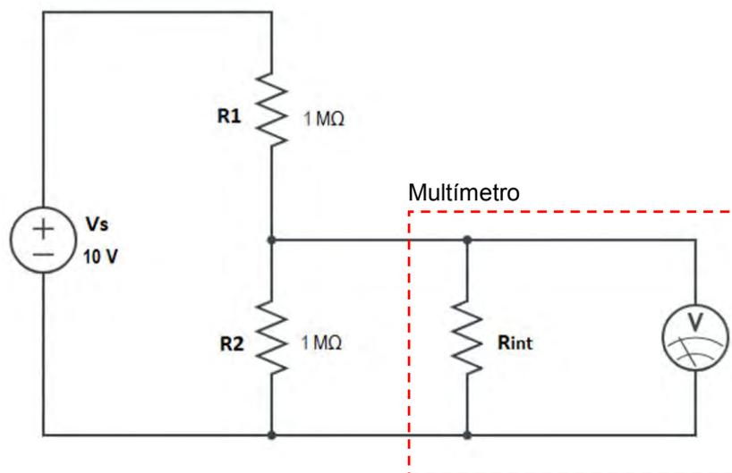
Teniendo en cuenta la impedancia interna del multímetro se tiene una resistencia equivalente al paralelo entre  $R_2$  y  $R_{int}$  y la medición de tensión eléctrica sobre la resistencia  $V_{R_2}$ , realmente sería:
