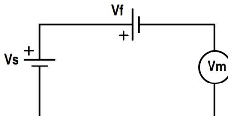
Por lo tanto, el valor de tensión medido será  $V_m = V_S - V_f$ , es decir se tendrá un error adicional debido a la FEM térmica del circuito  $V_f$
