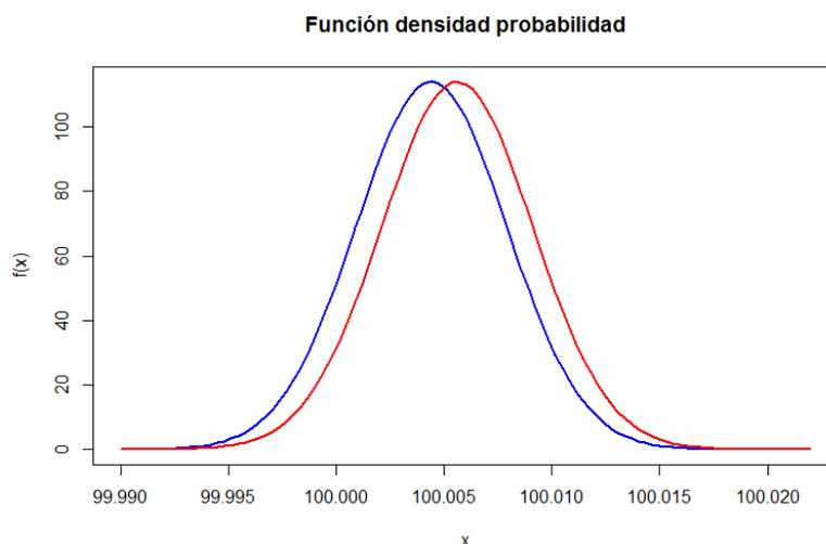
Es evidente la compatibilidad de los resultados, de hecho, empleando el error normalizado se obtiene  $E_n = 0.11$ , es decir resultados completamente compatibles.
