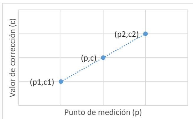
Si se tienen los resultados de calibración  $(c_1, c_2)$  de un patrón de medida en dos puntos de medición  $(p_1, p_2)$  y se desea estimar su valor de corrección  $c$  en un punto intermedio  $p$  se puede realizar una interpolación, cuyo modelo es el siguiente:
