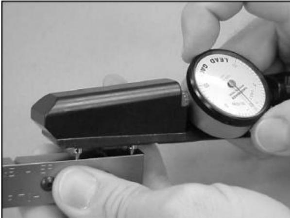
**Figura 5** Medidor de paso de rosca y patrón de ajuste (Gagemaker, 2012)
