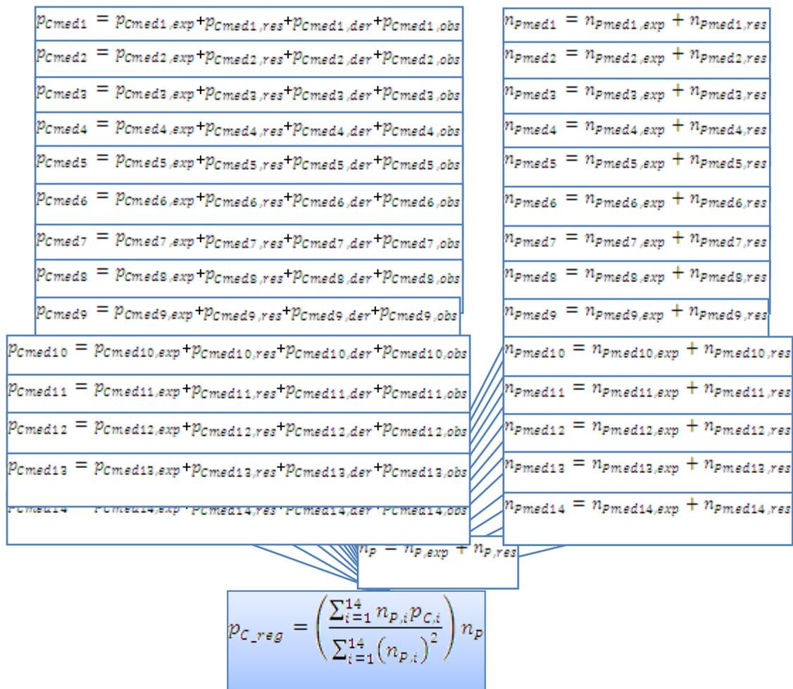
**Figura 2.** Modelo de medición de posición de la campana, a partir de regresión lineal de datos experimentales “posición de la campana” vs. “número de pulsos”.
