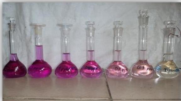
Ilustración 1. Método 1, 5-difenilcarbazida para la identificación de Cr (VI), para el análisis de las variables óptimas de adsorción, gráfico 2.
