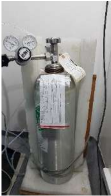
Cilindro de Gases EPA (NO, SO2 y CO)
