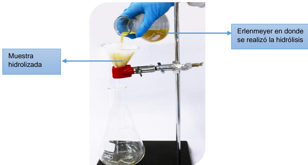
Figura 2. Filtración de la muestra hidrolizada.
