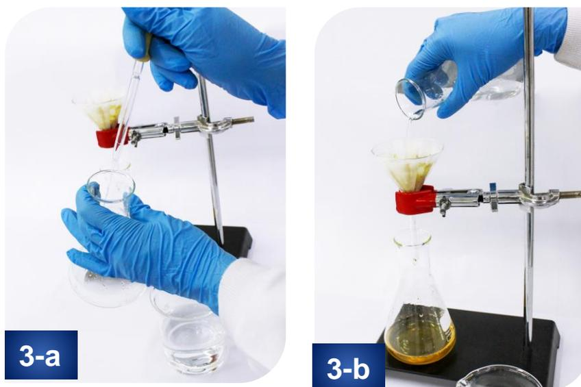
Figura 3. a) Lavado del Erlenmeyer utilizado para la hidrólisis. b) Adición del lavado a la muestra hidrolizada
