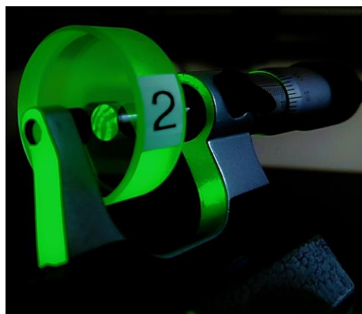
Figura 5 Paralelas ópticas y franjas de interferencia
