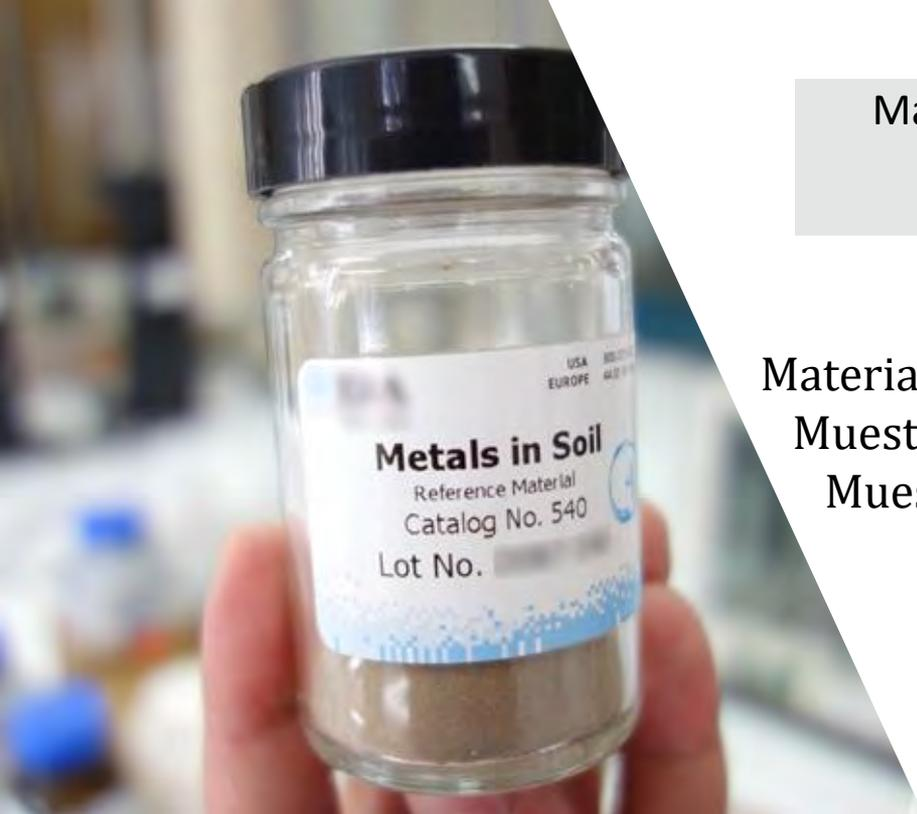
Material de referencia para uso de rutina que permite **determinar la precisión** de los procedimientos de ensayo
