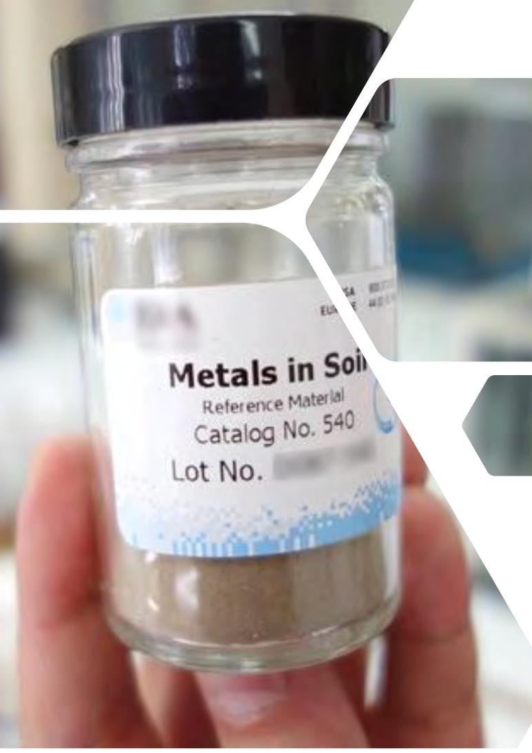
Material de referencia para uso de rutina que permite **determinar la precisión** de los procedimientos de ensayo
