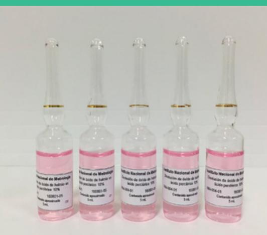
Oxido de Holmio para calibración de espectrofotómetros
